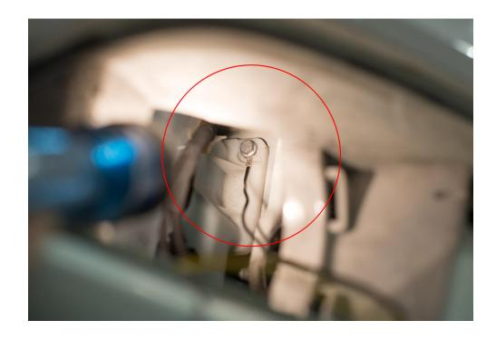
6. CONNECT THE PASSENGER SIDE CONNECTOR TO THE PASSENGER SIDE FOG LIGHT. THE PASSENGER SIDE FOG LIGHT HAS A "R" ON THE REAR OF THE HOUSING.
