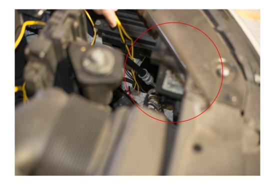
3. ROUTE THE SHORTER LEAD WITH THE BLUE PLUG THROUGH THE OUTER HOLE IN THE DRIVER SIDE OF THE BUMPER (RED ARROW). ROUTE THE LONGER LEAD WITH THE BLUE PLUG THROUGH THE INNER HOLE IN THE DRIVER SIDE OF THE BUMPER (BLUE ARROW).
