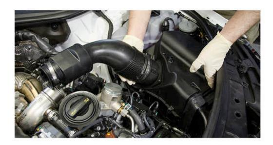
6. REMOVE THE PASSENGER SIDE INTAKE PIPE FROM THE TURBO INLET PIPE. ONCE THE INTAKE PIPE IS DISCONNECTED GRASP THE FACTORY AIR BOX AND PULL UPWARDS TO REMOVE THE AIR BOX.
