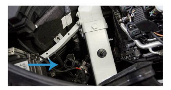
8. REMOVE THE RUBBER GROMMET FROM THE DRIVER SIDE AIR BOX.
