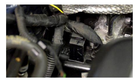
14. USING A SMALL FLAT HEAD SCREW DRIVER, REMOVE THE COVER ON THE BACK OF THE ABS WIRE HARNESS.
