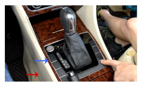
2. REMOVE THE TRIM PANEL LOCATED RIGHT BELOW THE SHIFTER BY PRYING ONE CORNER WITH A PLASTIC WEDGE TOOL.
